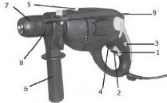
Nehmen Sie den Griff »6«, entfernen Sie die Schraube, die den Kragen des Gehäuses zusammenhält. Führen Sie den Kragen auf den Ring der Bohrmaschine. Drehen Sie den Griff in die gewünschte Position und ziehen Sie die Schraube am Ring fest. Stellen Sie sicher, dass der Griff fest ist, bevor Sie mit der Arbeit beginnen.
