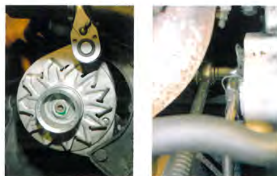
Foto links: Die Lichtmaschine ist am Halter, dieser am Zylinderkopf befestigt. Fotos unten: Lösen der Schrauben/Muttern SW 17, Blick auf die Verkabelung, gespannter Riemen.
